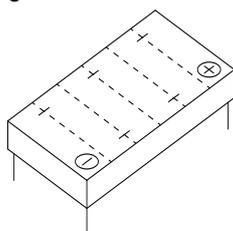
**Technologie** Verschlossene GEL-Batterie | Elektrolyt gelartig gebunden | gefüllt und geladen | absolut wartungsfrei
